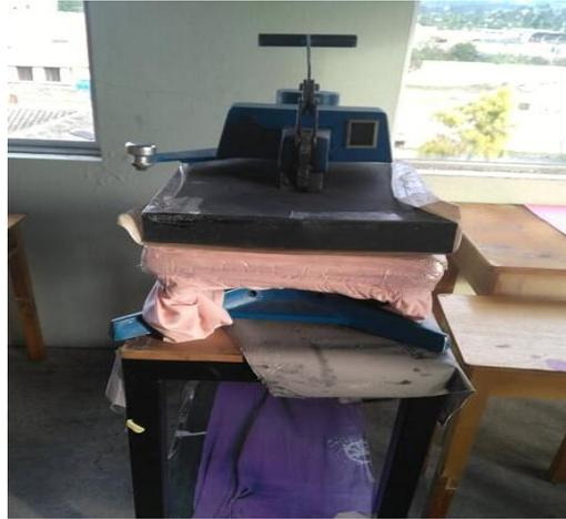
**Figura 12:** Plancha térmica de fijación de pintura
