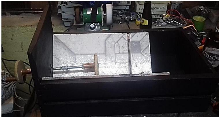
**Figura37** *Maquina cortadora de botellas*
