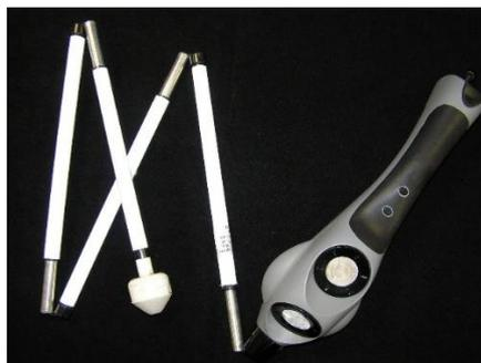
**Figura 2** Ultracane. Detecta obstáculos mediante ondas ultrasónicas.
