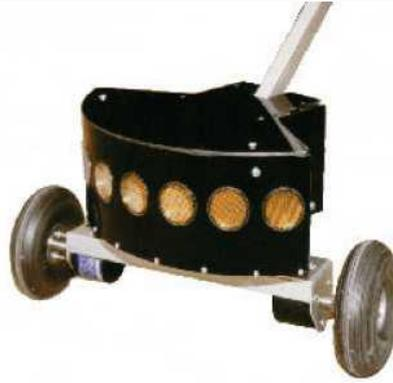
**Figura 1** GuineCane. Compuesto por diez sensores ultrasónicos.
