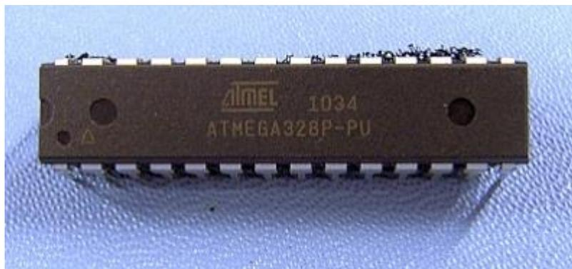
**Figura 4** Circuito Integrado ATmega328p
