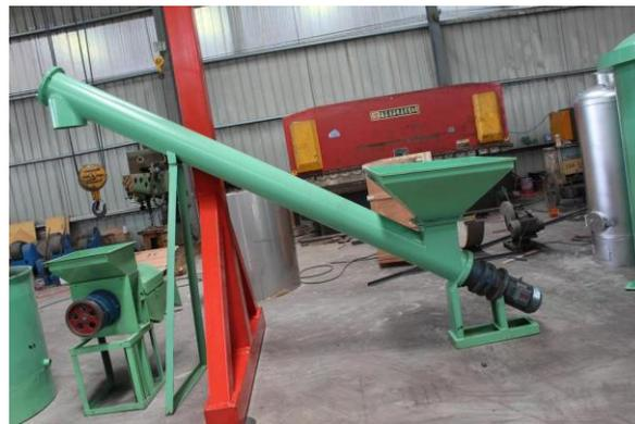
Figura 10: Transportador de tornillo
