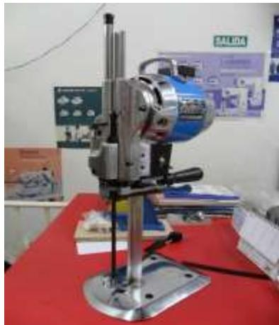
Figura 4 Máquina cortadora de tela
