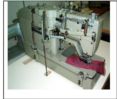
**Figura 29: Máquina Ojaladora**
