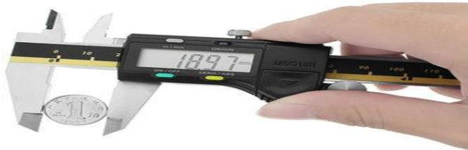
Figura N°. 54 Calibrador digital
