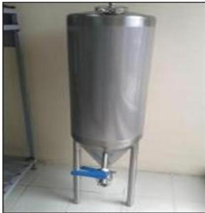
Figura N°34 Tanque de mezcla
