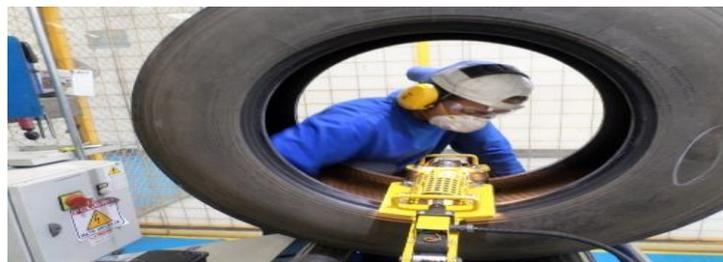
Para que un neumático sea considerado apto para reencauche, debe ser inspeccionado en su totalidad por el operador conforme se establece en la Instrucción de Trabajo IT-II-001 Inspección inicial, para determinar si las carcasas pueden ser reencauchadas o no.
