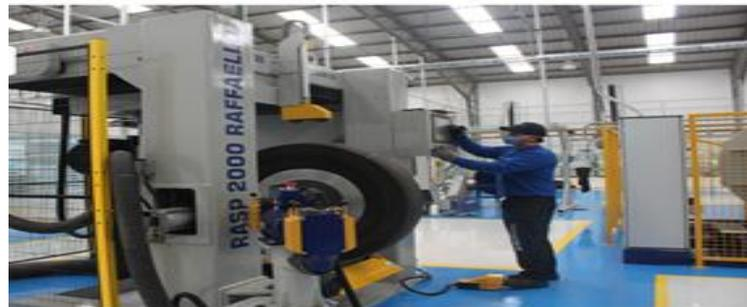
Consiste en remover la banda de rodamiento original y preparar la superficie para recibir una nueva banda de rodamiento, dejando la carcasa con una textura adecuada, manteniendo los criterios establecidos en el literal 5.3 de la Norma técnica NTE-INEN 2582:2011, Ver figura 1; mejorando así la circunferencia de la carcasa y proporcionando un radio de pulido uniforme.
