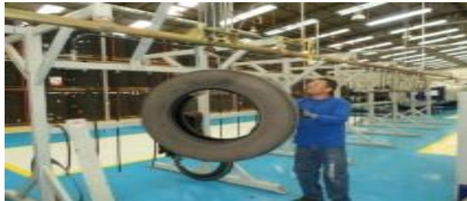
En el caso de llanta radial, se coloca una camisa elástica que cubre la llanta interna (innerlope) y externamente (envelope) para protegerla de la temperatura y presión dentro del autoclave durante la vulcanización, está cubierta permite una correcta distribución de la presión interna o tercera presión (DPC) para promover un correcto vulcanizado
