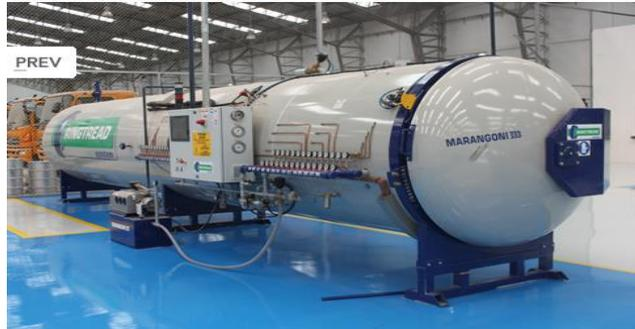
El vulcanizado se realiza en el autoclave con capacidad para 28 neumáticos, pudiéndose colocar 24 neumáticos radiales o una mezcla de 12 radiales y 16 convencionales.
