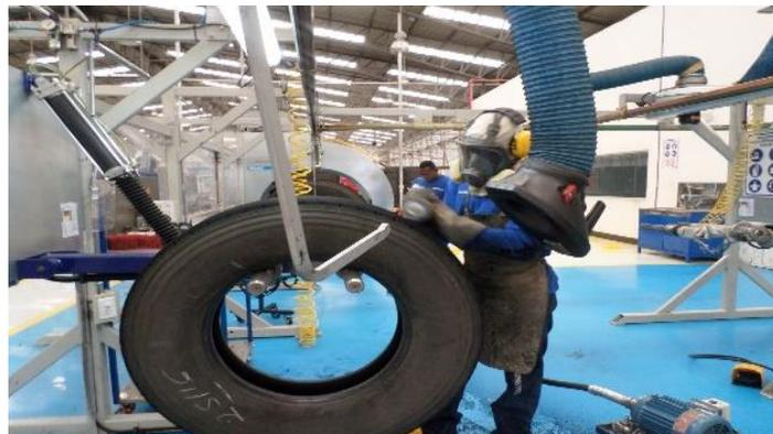
Esta etapa consiste en remover de manera profunda y en detalle cualquier imperfección producida en el proceso de pulido que pueda afectar la correcta adhesión banda-carcasa acorde se lo establece en la Instrucción de trabajo IT- REP-001 Reparación (Escareado) en este proceso se retira elementos no deseables como caucho quemado, cables de acero, alambres o hilos dañados u oxidados, etc; que estén presente en la carcasa.
