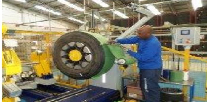
Consiste en aplicar la nueva banda de rodamiento pre curada según las dimensiones de corona (ancho y radio), base y espesor, como se requiera para el tamaño y diseño de matriz/molde en la cual el neumático va a ser vulcanizado estos parámetros se indican en la IT-EMB-001 Embandado.
