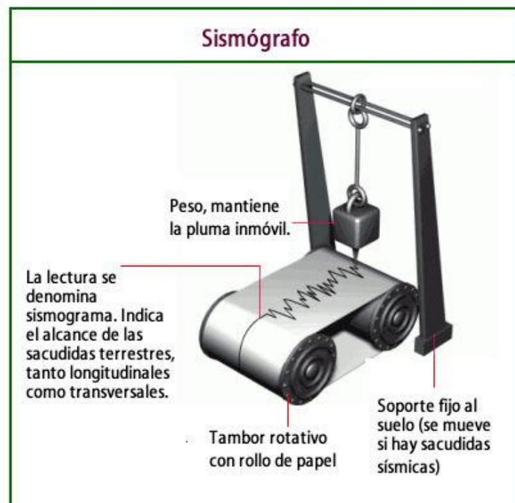
Figura 5. Sismógrafo
