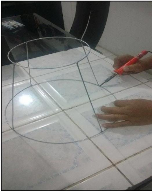
Para el proceso del armado de la base de la campana se procede al corte y alineación del alambre
