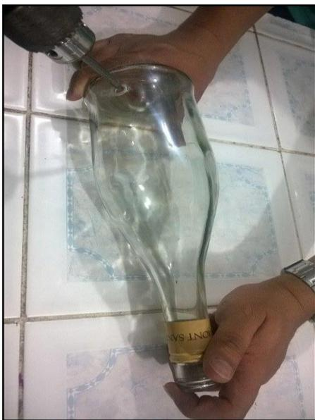
Para el proceso del perforado de la botella se tiene que realizar a baja velocidad para iniciar el orificio es importante no usar toda la potencia ya que se podría quebrar el vidrio.
