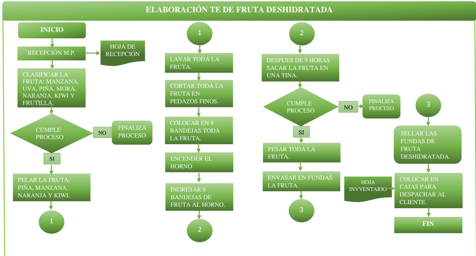
Figura 21 Flujo grama del Proceso al Elaborar Te Fruta Deshidratada
