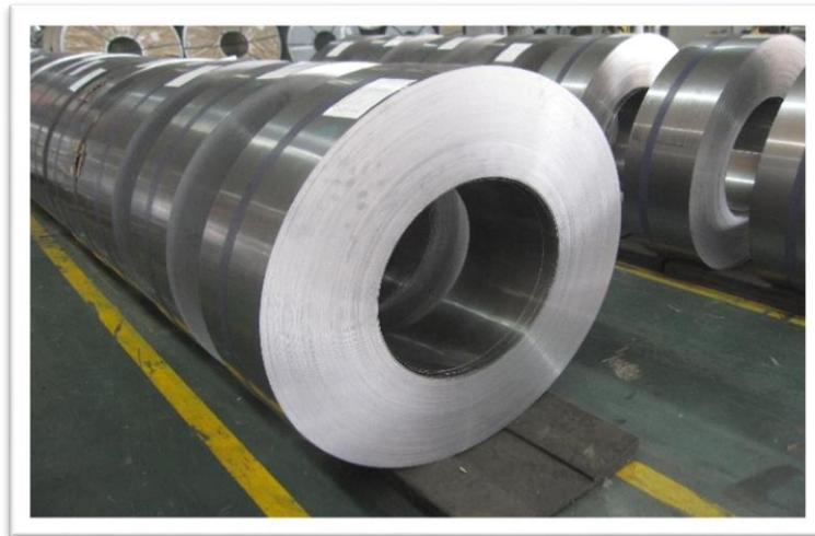
Son bobinas de metal que tiene un peso promedio de 250 kilogramos cada una para la fabricación de las puertas se adquieren un mínimo de 7 bobinas
