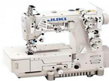
Figura 32: Máquina recubridora JUKI
