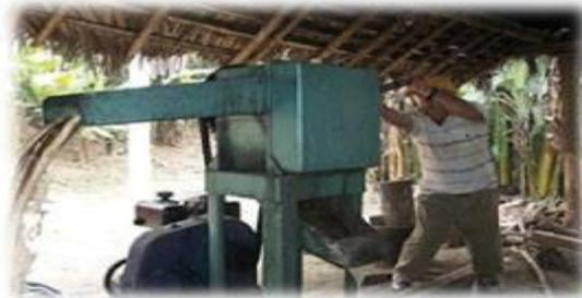
El proceso de molido de la caña debe ser continuo después del corte o en el tiempo máximo de 48 horas después. Las mondas deben ser lavadas antes y después de moler la caña. Muy importante que abajo de las mondas, antes del tanque de decantación, debe ser colocado un cernidero o una malla para separar las impurezas (bagacitos) que se extraen con el jugo.
